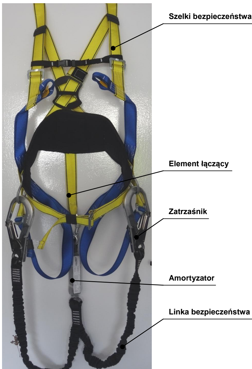
Rys. 1. Przykładowy zestaw zabezpieczający montera przed upadkiem z wysokości [1]
