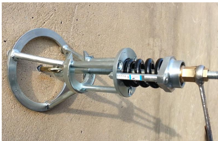
Rys. 34. Przykładowe urządzenie do sprawdzania zakotwień (BUK-O2P)[9].
