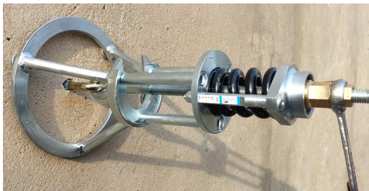
Rys. 12. Przykładowe urządzenie do sprawdzania siły wyrywania kotew (Buk-O2P) [9].
